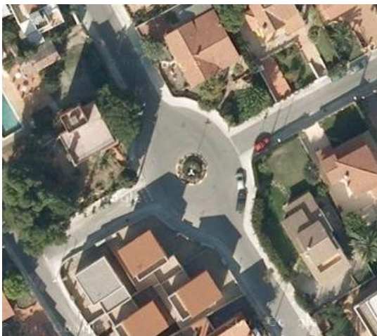
Imatge 18. Plaça Art, en la intersecció entre les avingudes Alella i Teià. L'illot central té un radi molt reduït i els carrils anuals, en comparació, son massa amples. Aixó provoca que vehicles estacionen dins la rotonda.
