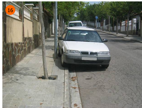
16 Invasió de la vorera per a l'estacionament. El carrer ofereix dos sentits de circulació. En àrees residencials de baixa demanda, és preferible establir ordenació de sentits únics si la demanda d'estacionament no és satisfeta suficientment fora de calçada.
