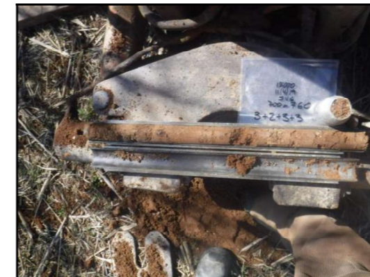
Foto 15: Sondeig Sv-6, SPT a 7,0 metres.
