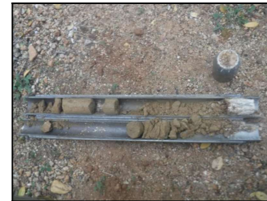
Foto 37: Sondeig S-6, SPT a 5,5 metres.
