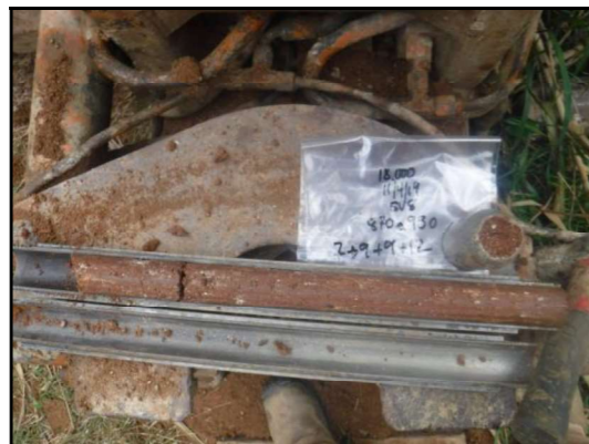
Foto 21: Sondeig Sv-8, SPT a 8,7 metres.
