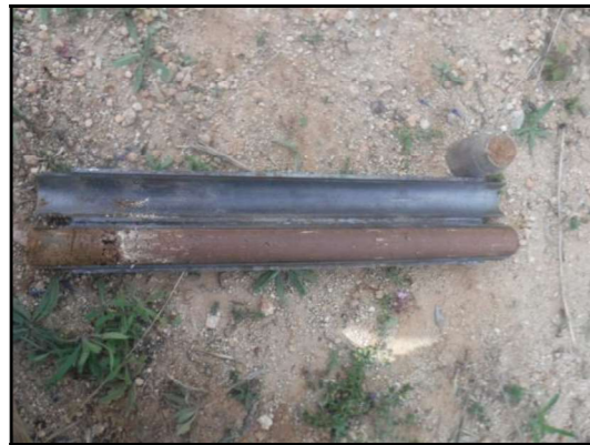
Foto 31: Sondeig S-5, SPT a 0,7 metres.
