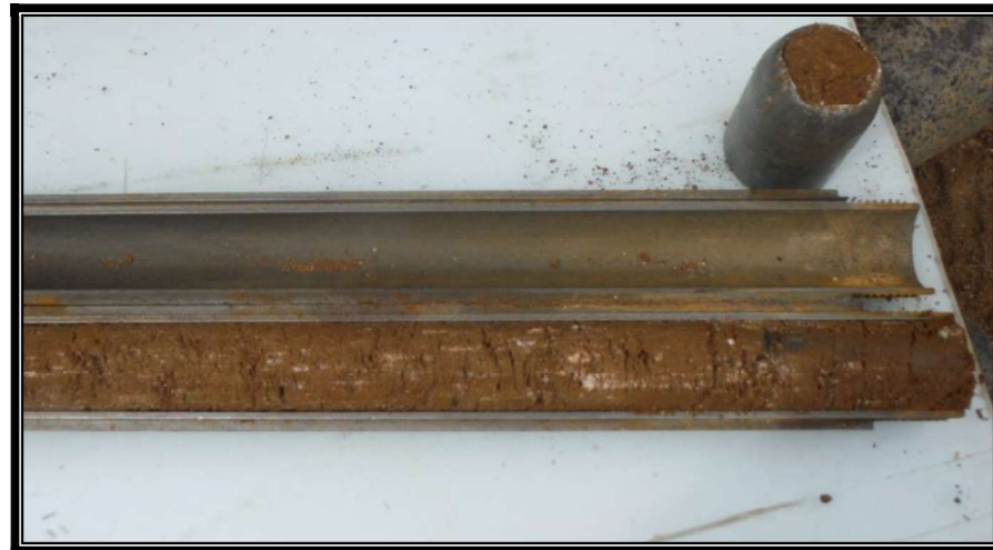
Aspecte dels materials de la capa H, recuperats a un SPT.
