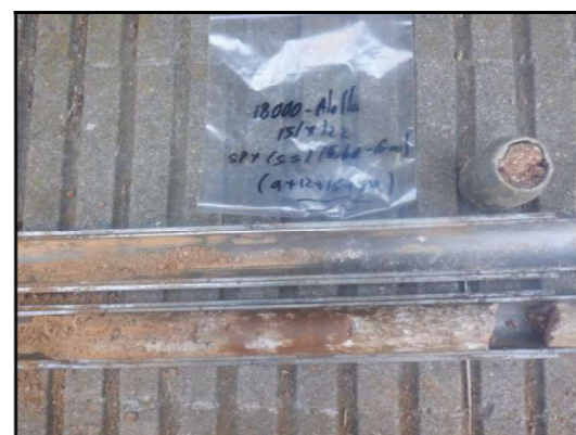
Foto 15: Sondeig Ss-5, SPT a 5,4 metres.
