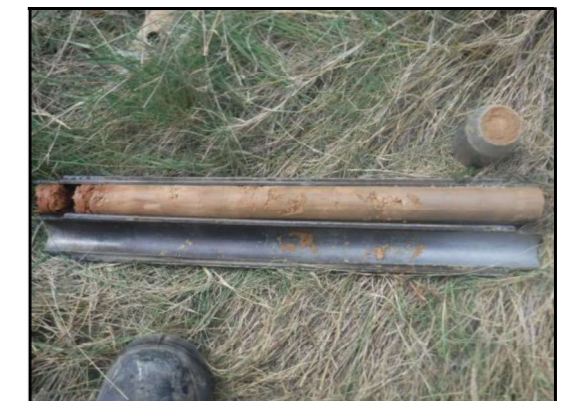
Foto 28: Sondeig S-2, SPT a 3,8 metres.
