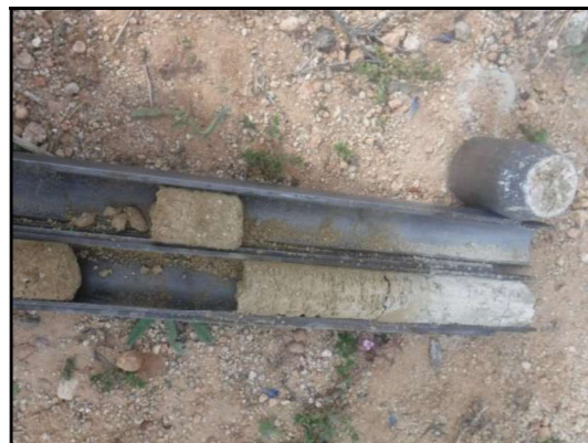
Foto 33: Sondeig S-5, SPT a 4,6 metres.
