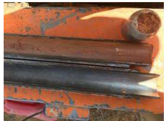
Foto 45: Sondeig Sc-6, SPT a 2,4 metres.
