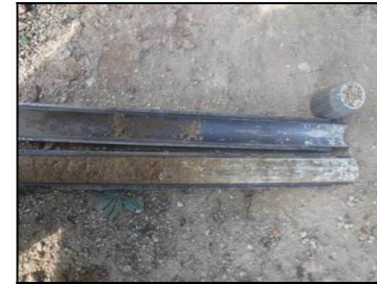
Foto 25: Sondeig S-1, SPT a 5,5 metres.
