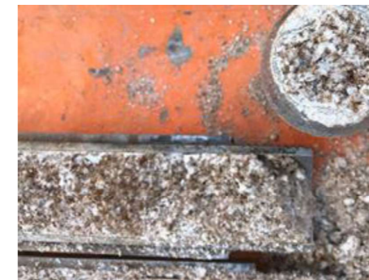
Foto 39: Sondeig Sc-3, SPT a 2,7 metres.
