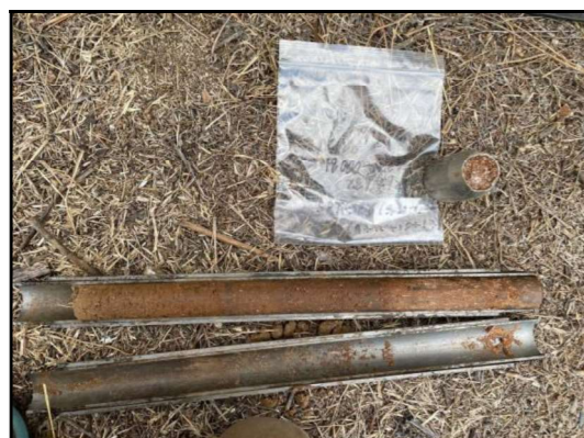
Foto 35: Sondeig Sp-6, SPT a 5,4 metres.
