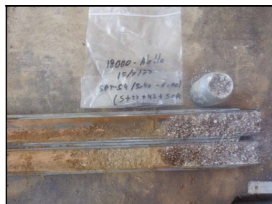
Foto 12: Sondeig Ss-4, SPT a 5,4 metres.
