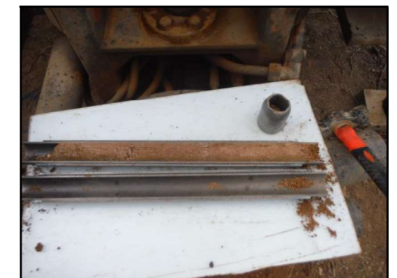
Foto 6: Sondeig Sv-3, SPT a 1,5 metres.
