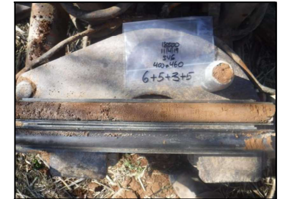
Foto 14: Sondeig Sv-6, SPT a 4,0 metres.
