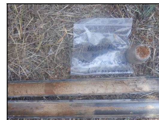
Foto 18: Sondeig Sp-1, SPT a 5,4 metres.
