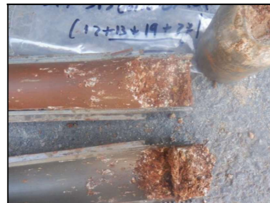
Foto 24: Sondeig Sp-3, SPT a 6,3 metres.
