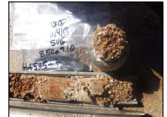
Foto 16: Sondeig Sv-6, SPT a 8,5 metres.
