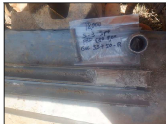
Foto 9: Sondeig Ss-3, SPT a 6,8 metre.
