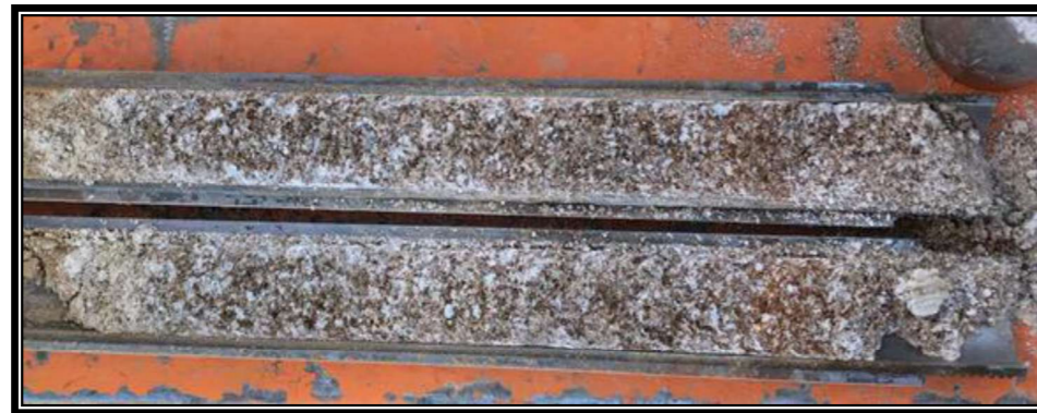
Detall dels materials de la capa B, recuperats a un assaig SPT.
