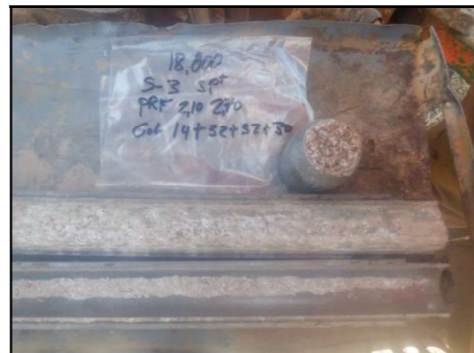
Foto 8: Sondeig Ss-3, SPT a 2,1 metres.
