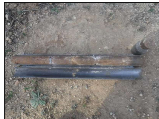
Foto 24: Sondeig S-1, SPT a 2,8 metres.
