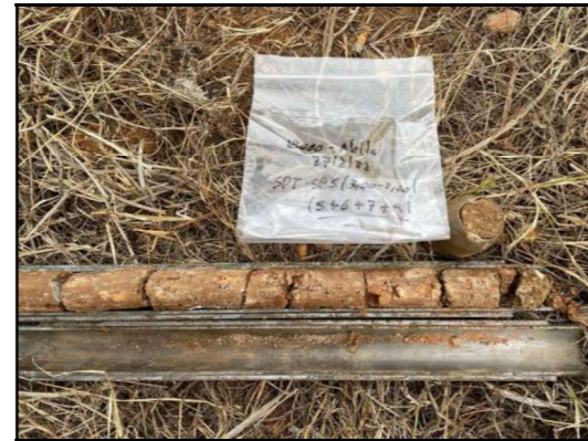
Foto 32: Sondeig Sp-5, SPT a 5,4 metres.
