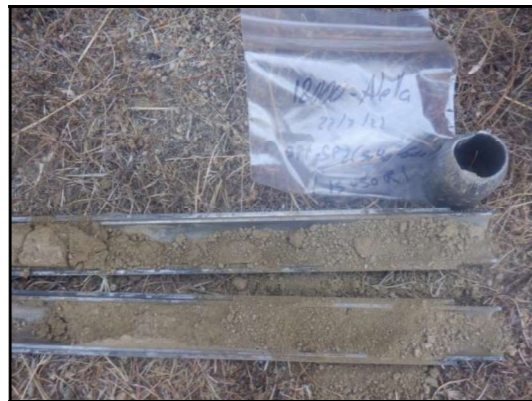
Foto 21: Sondeig Sp-2, SPT a 5,4 metres.
