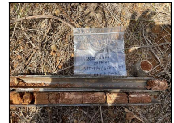
Foto 28: Sondeig Sp-4, SPT a 5,4 metres.
