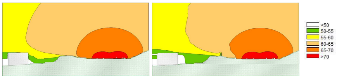
Figura 10. Comparativa de la secció transversal sense i amb mesures correctores complementaries (Receptor ED4).
