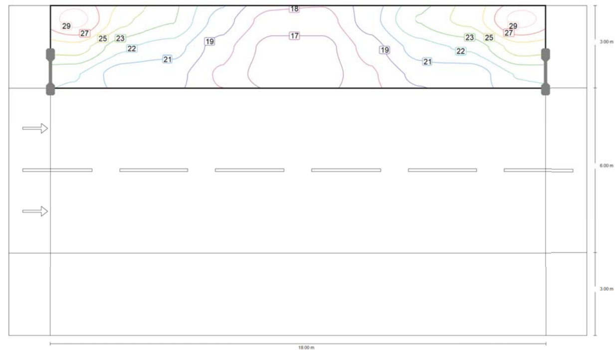
Valor de mantenimiento iluminancia horizontal [lx] (Líneas Isolux)
