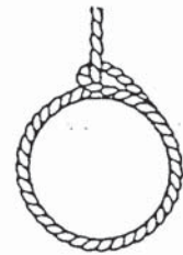
Malo - El ajuste de ojal corta el cable en movimiento.
