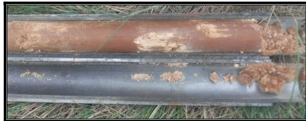
Aspecte dels materials cohesius, recuperats a un SPT.
