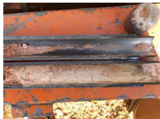
Foto 47: Sondeig Sc-7, SPT a 2,4 metres.
