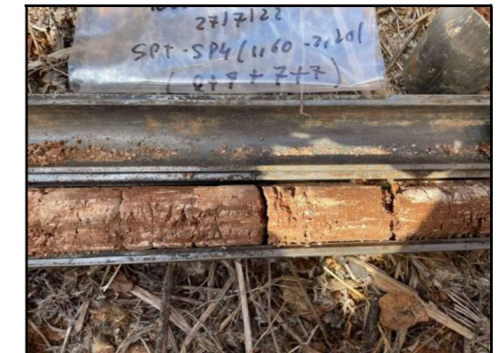
Foto 26: Sondeig Sp-4, SPT a 1,6 metres.
