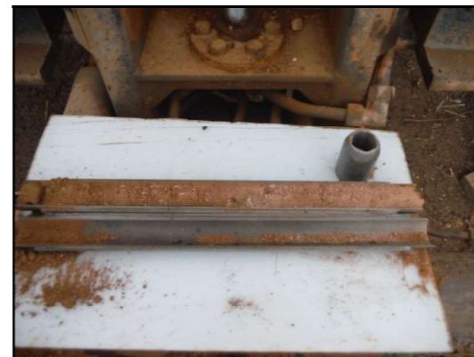
Foto 10: Sondeig Sv-5, SPT a 4,0 metres.
