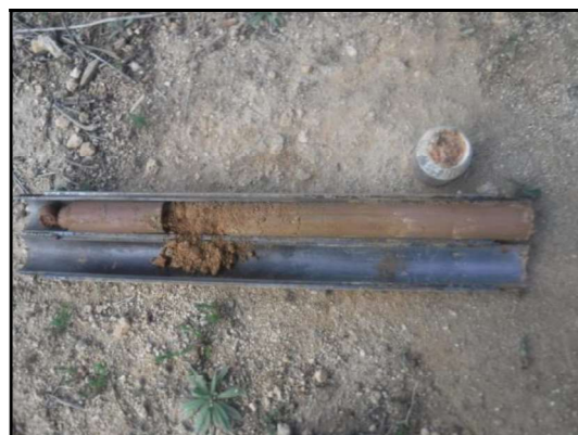
Foto 23: Sondeig S-1, SPT a 1,1 metres.
