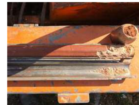
Foto 41: Sondeig Sc-4, SPT a 3,6 metres.
