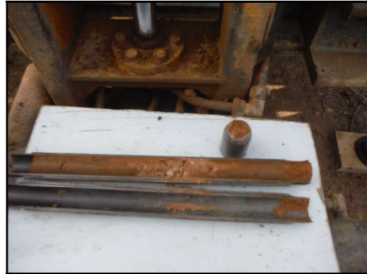
Foto 7: Sondeig Sv-3, SPT a 5,4 metres.
