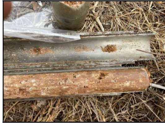
Foto 31: Sondeig Sp-5, SPT a 3,0 metres.
