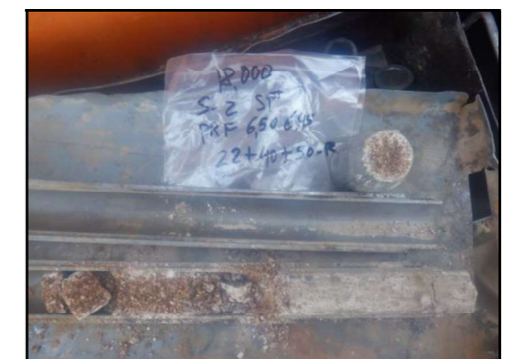
Foto 6: Sondeig Ss-2, SPT a 6,5 metres.
