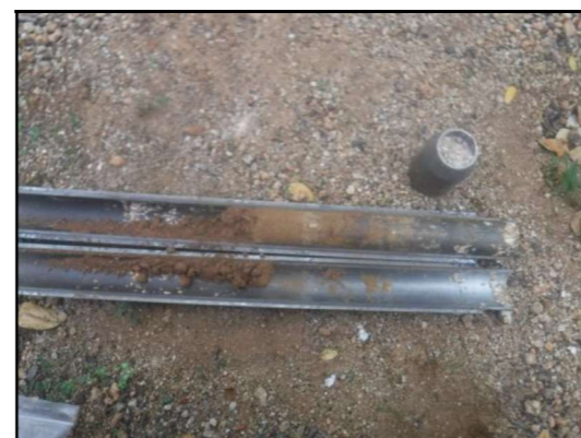
Foto 36: Sondeig S-6, SPT a 2,8 metres.
