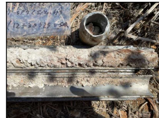
Foto 27: Sondeig Sp-4, SPT a 5,4 metres.
