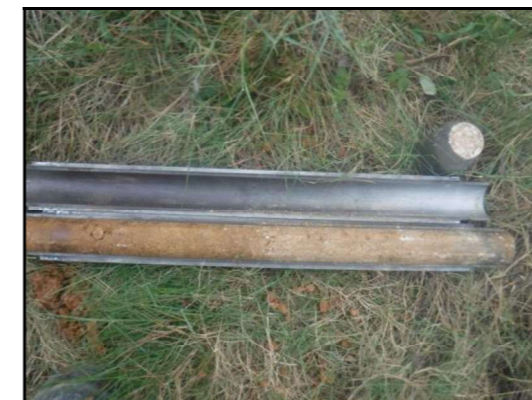
Foto 29: Sondeig S-2, SPT a 7,4 metres.
