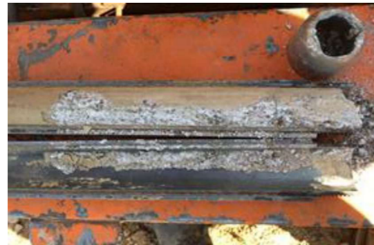
Foto 43: Sondeig Sc-5, SPT a 2,4 metres.
