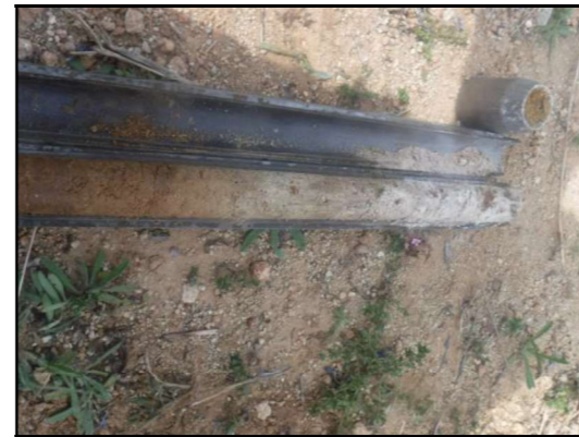
Foto 32: Sondeig S-5, SPT a 2,6 metres.
