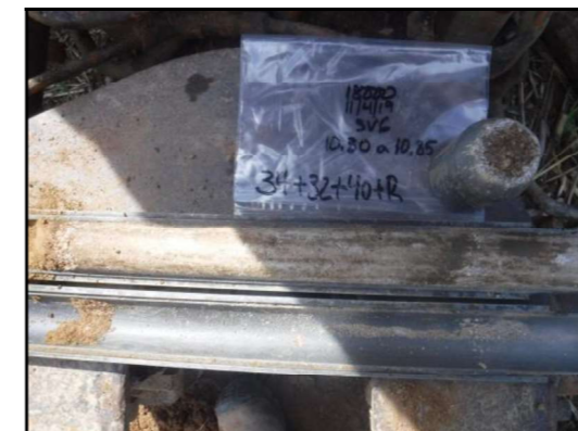
Foto 17: Sondeig Sv-6, SPT a 10,3 metres.
