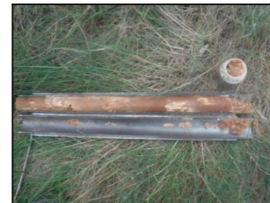
Foto 27: Sondeig S-2, SPT a 1,6 metres.
