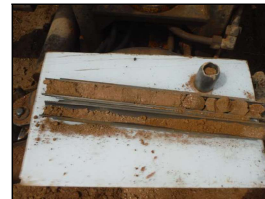
Foto 3: Sondeig Sv-1, SPT a 3,2 metres.
