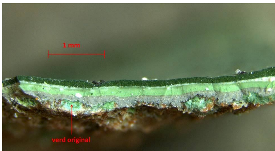
Micrografia a 25x de la mostra 4: serralleria barana. S'observa que sota diferents repintats, l'estrat original correspon a un acabat verd, contratipat com a Color F.
