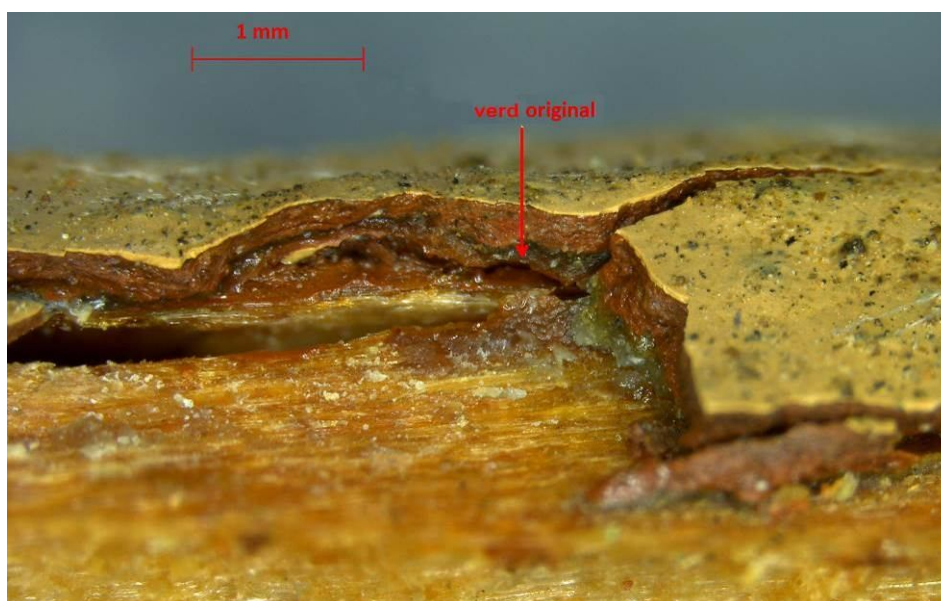
Micrografia a 25x de la mostra 6: fusteria balconeres. Sota diferents estrats s'ha descobert el verd original, que es correspon al Color E.
