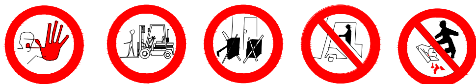
ALTO NO PASSAR PROHIBIT ACOMPANYANTS EN CARRETÓ PROHIBIT DIPOSITAR MATERIALS: MANTENIR LLIURE EL PAS PROHIBIT EL PAS A CARRETONS PROHIBIT TREPITJAR TERRA NO SEGUR
