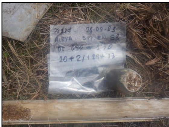
Foto 7: Sondeig S-3, SPT a 0,9 metres.
