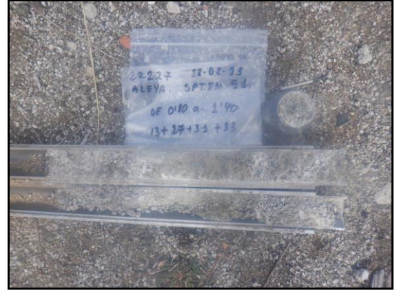
Foto 2: Sondeig S-1, SPT a 0,8 metres.
