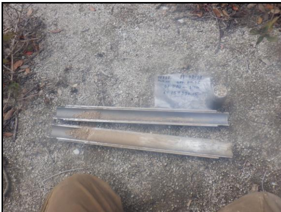
Foto 5: Sondeig S-2, SPT a 0,8 metres.
