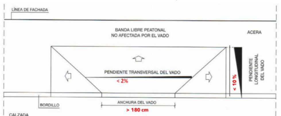
Figura 22. Esquema d'un gual
